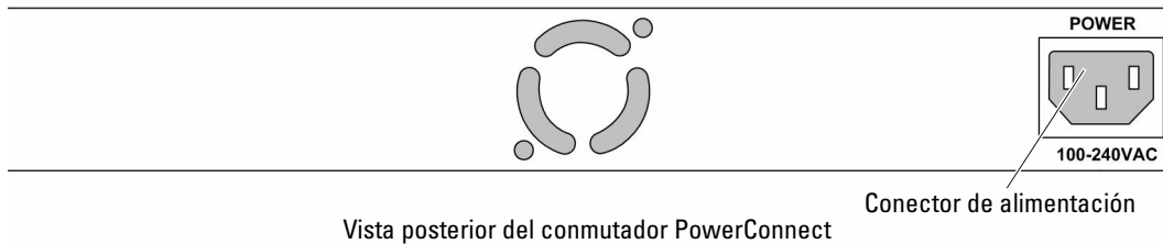
Figura 1-4. Conectores de alimentación del panel posterior
